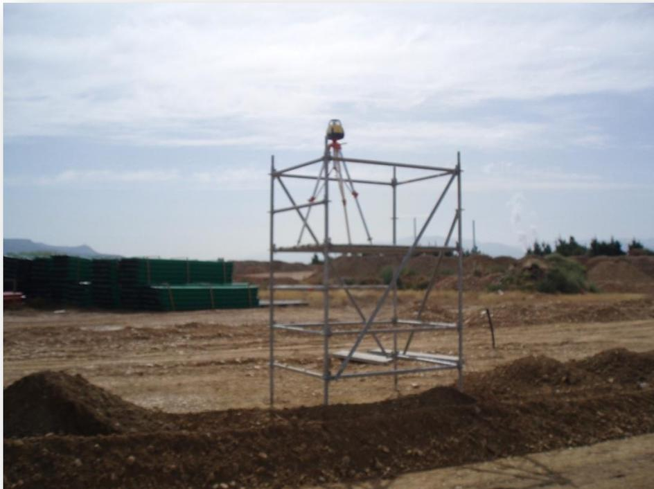
Fig. 7 Emisor de Láser sobre un andamio para conseguir altura suficiente
