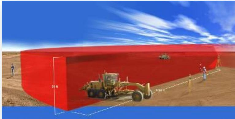
Fig. 20 Volumen cubierto por un solo emisor Lazer Zone en el sistema 3D milimétrico (600 m de radio x 10 m de altura)[21]
