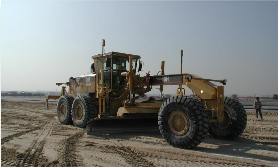
Fig. 8 Motoniveladora equipada con dos sensores de láser trabajando en un aeropuerto
