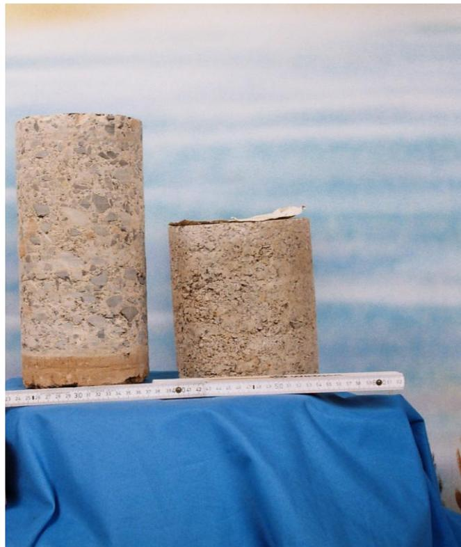
**Fig. 5 Testigo y probeta de una capa de suelocemento in situ**
