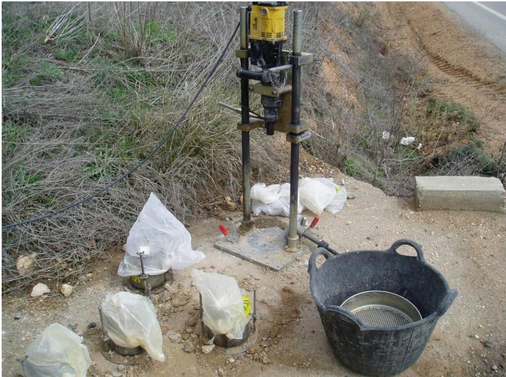
**Fig. 4** Confección de probetas in situ
