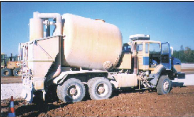
Fig. 8 - Extendido de la cal.
