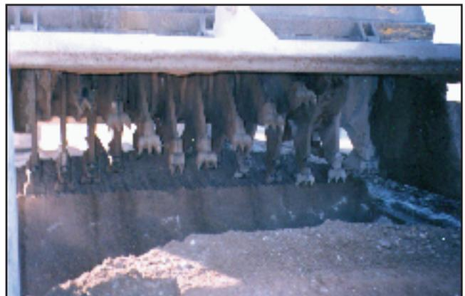
Fig. 14. Rotor con palas para el mezclado.
