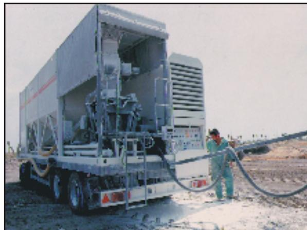
**Fig. 17.** Mezclador móvil agua-cal WM400
