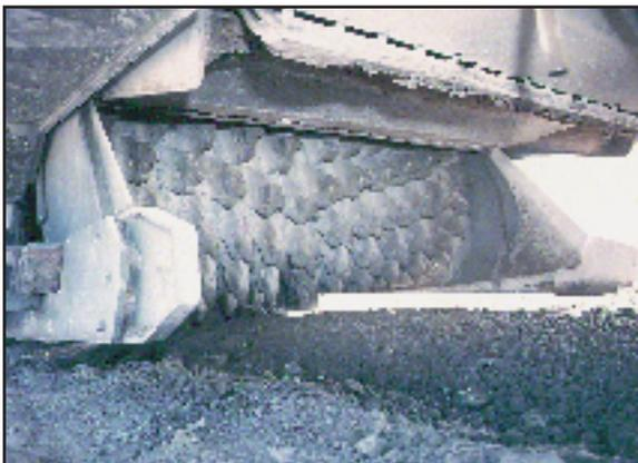
Fig. 15. Rotor con picas para el mezclado.
