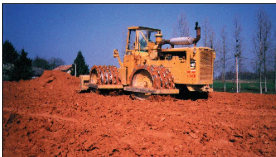
Fig. 19. Compactadora de pata de cabra.
