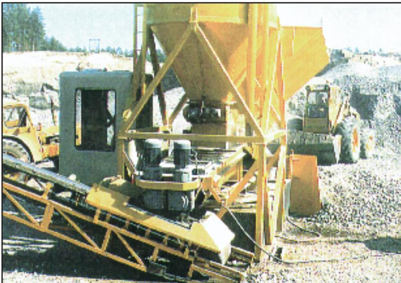
Fig. 18. Central mezcladora de arcilla de doble eje.(Belmix)
