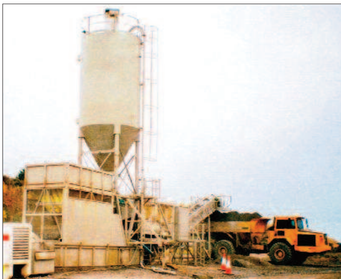
Figura 5.37 Planta móvil de 400 t/h, sin tolva de regulación, cargando un vehículo extravial
