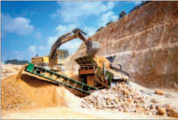
Figura 5.6 Criba sobre ruedas con alimentador de vaivén
