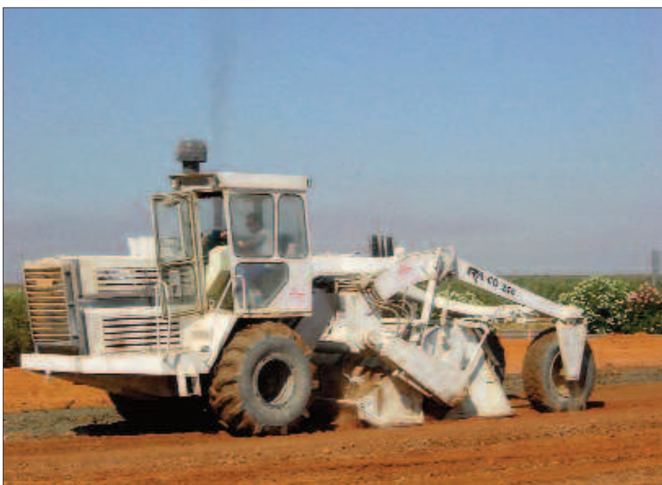
Figura 5.18 Máquina con el rotor centrado entre ambos ejes y motor sobre un eje
