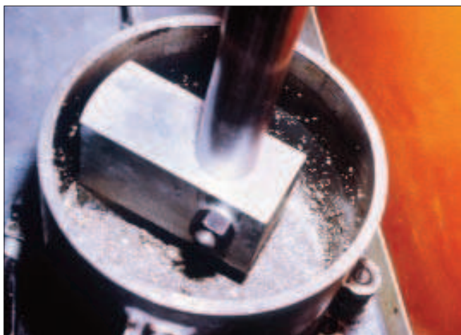
Figura 4.1 Compactación Proctor modificado
