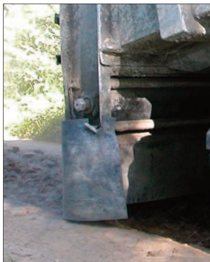
Figura 8.1 Detalle de faldón de protección de un distribuidor de conglomerante
