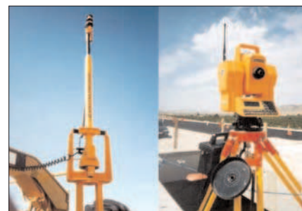
Figura 5.32 Estación total robotizada y prisma activo del sistema 3D
