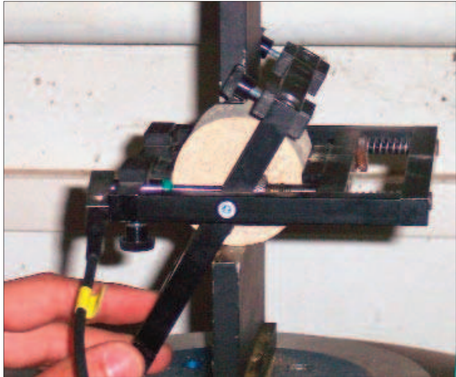
Figura 4.10 Realización de ensayo de tracción indirecta para la determinación del módulo de elasticidad
